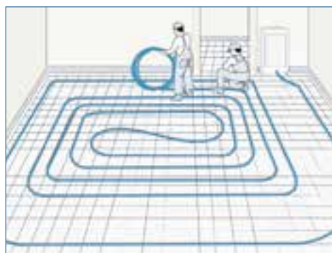
Обратную часть трубы укладывать „с поворотом” между витками подводящей части трубы.
