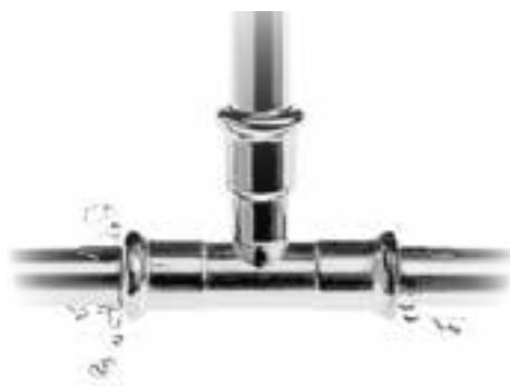
Действие O-Ring с функцией выявления неопрессованных соединений (LBP).
