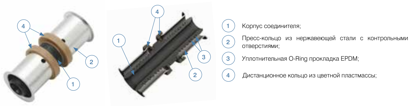
Рис. А. Общий вид и вид в разрезе соединителя KAN-therm Press LBP
